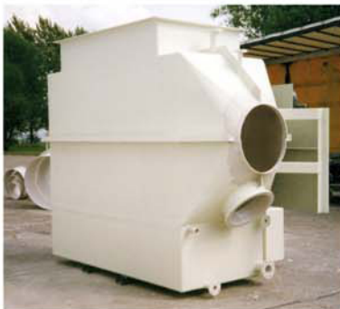
Kreuzstromwäscher Cross-flow scrubber
