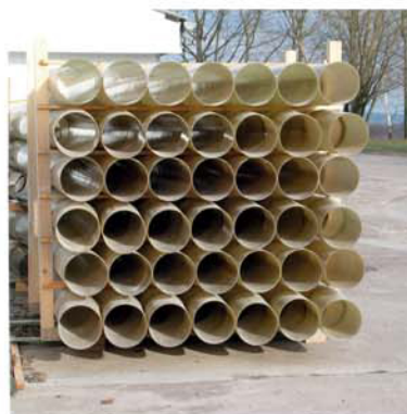
Rohrleitungen DN 300 aus GFK Pipelines DN 300, Material: FRP
