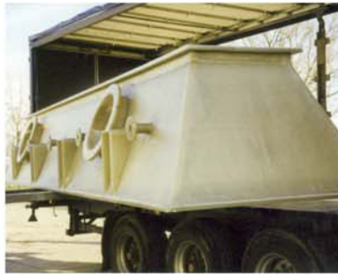
Verladung Wäschergehäuse Shipment scrubbershell
