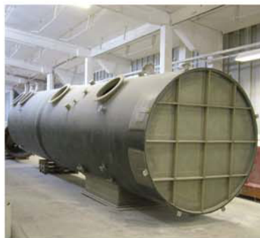
Wäschergehäuse Scrubber shell
