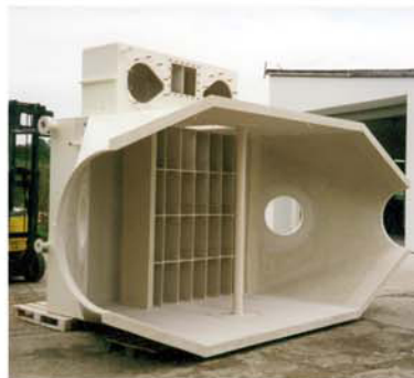
Wäschergehäuse Scrubber shell
