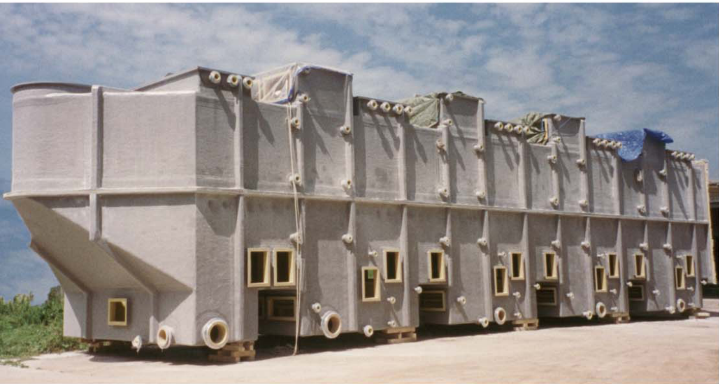
Ionisierende Nasswäscher aus GFK Länge: 25 m, Höhe: 6,0 m Breite: 6,0 m, Gewicht: 42.000 kg
